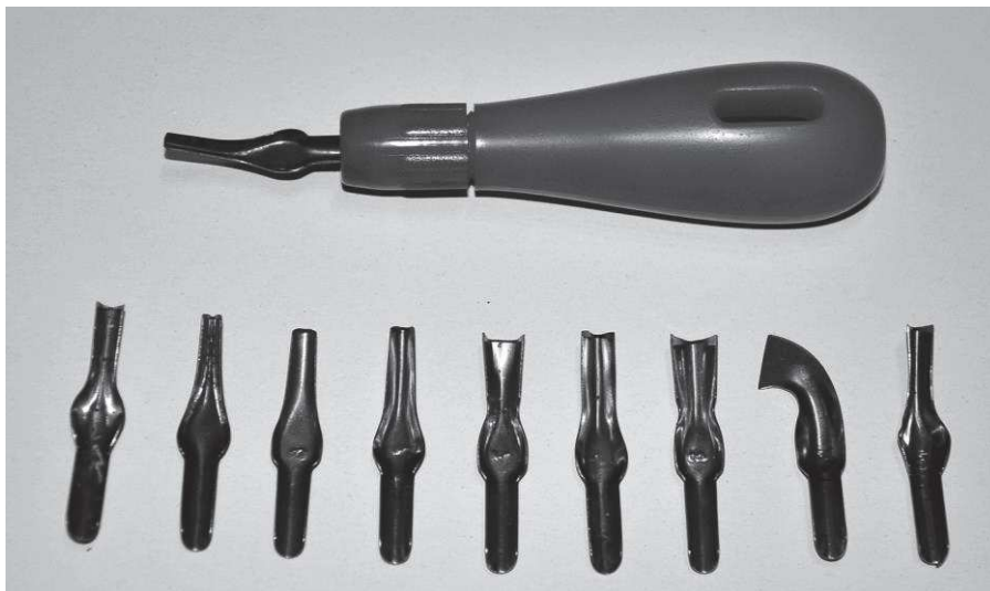
Fot. 1. Dłuta do linorytu (fot. A. Mazek)
