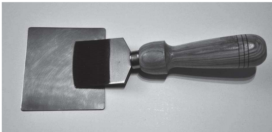
Fot. 4. Chwiejak do mezzotinty (fot. A. Mazek)
