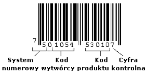
Rys.1. Struktura numeru w kodzie EAN-13
